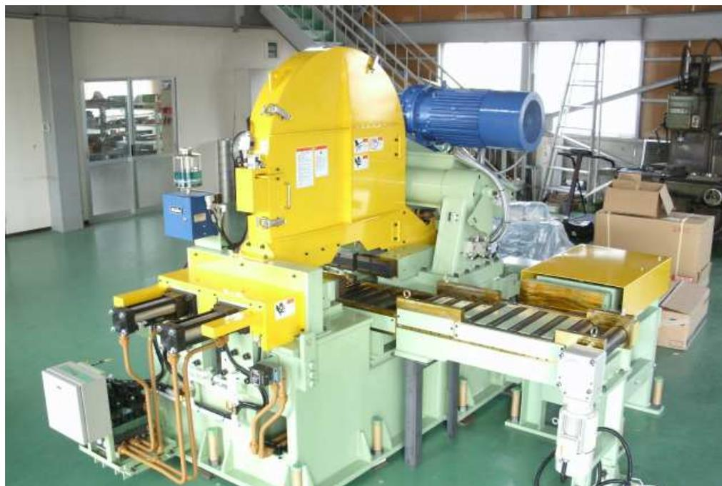
切断径 : 6インチ(150mm)～10インチ(250mm)に対応
