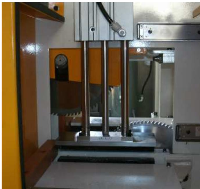
鋸径 :  $\phi 350\text{mm} \times 2\text{mmt}$ (上下共)
