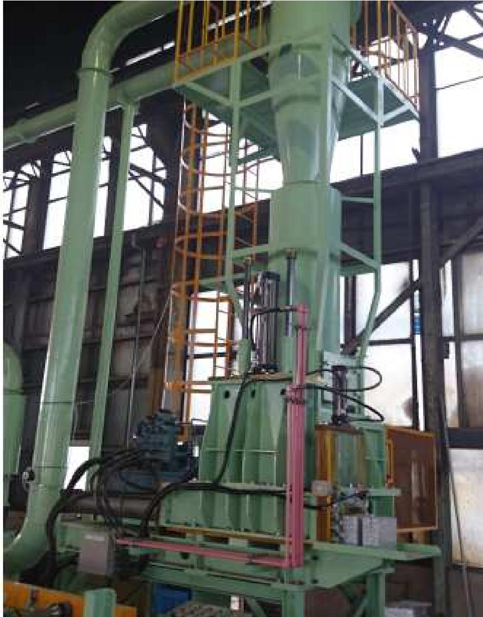
プレス能力 : 25Ton~50Ton(油圧シリンダ駆動)
